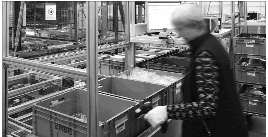
Abb. 4: Laserlichtgeführte und visuell gestützte Kommissionierung am AKL
